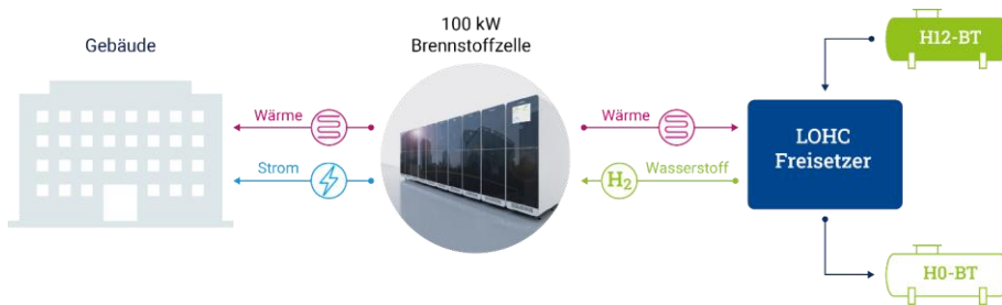
Abbildung 4: Schematische Darstellung der Wärmekopplung von SOFC-Brennstoffzelle und LOHC-Dehydrierung.
